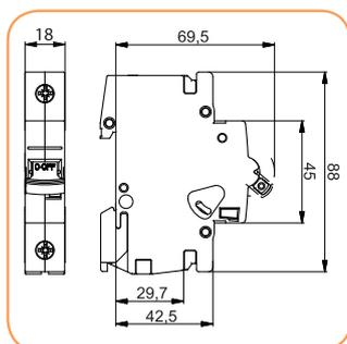
**Описание:** Независимый расцепитель DA ETIMAT P10 применяется для дистанционного отключения автоматических выключателей серии ETIMAT P10, ETIMAT P10 DC с номиналами от 0,5 до 63А и монтируется с правой стороны.
